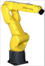
Robot polyarticulé 6 axes
