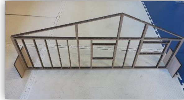
Prototype d'essai pour vérifier la stabilité géométrique d'une ossature plane en bois
