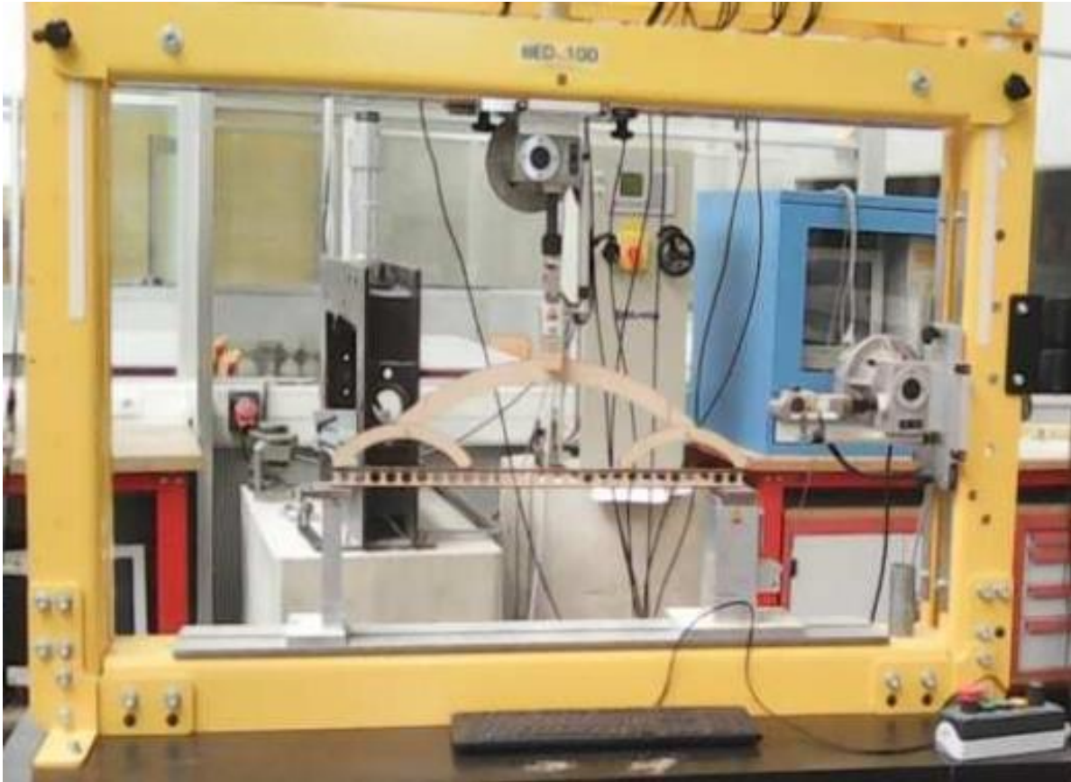
Prototype d'une poutre supportant 4 pannes
