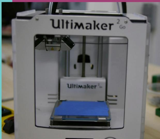
◆ **Imprimantes 3D** : les machines déposent couche par couche des fils de plastique pour obtenir un volume final en 3 dimensions
