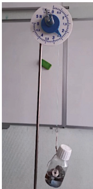
Figure 12 - Influence du volume d'eau déplacé sur la valeur de la poussée d'Archimède.
