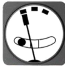
Inclinaison trop forte (glissade)
