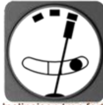
Inclinaison trop forte (glissade)
