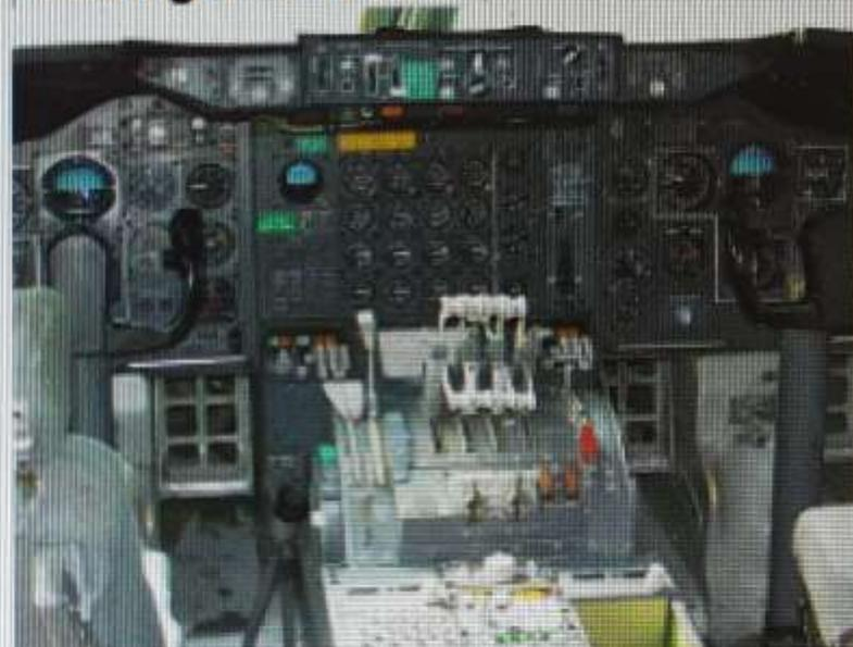
**Quarante ans séparent ces deux postes de pilotage.** La technologie du nouveau 747-8 est la même que celle utilisée sur le dernier-né des Boeing, le 787 Dreamliner. L'avion est passé d'un pilotage à trois (2 pilotes et un mécanicien navigant) à un pilotage à deux.
