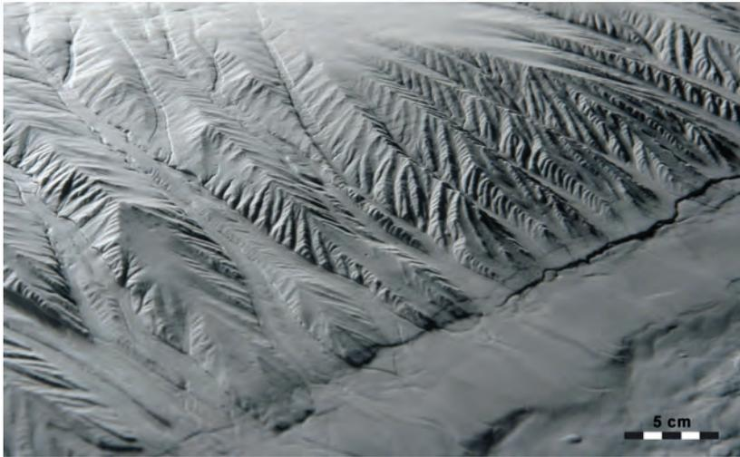
Fig. 3-4. – Modèle analogique réalisé à Géosciences Montpellier dédié à l'étude de l'évolution morphologique des reliefs au voisinage d'une faille normale. La topographie initiale du modèle était lisse et le stade actuel a été obtenu après 6 h d'expérience.
