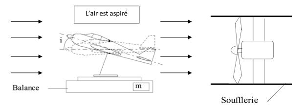
Voici les résultats des mesures de la balance relevant la variation de la « masse apparente » de notre avion.
