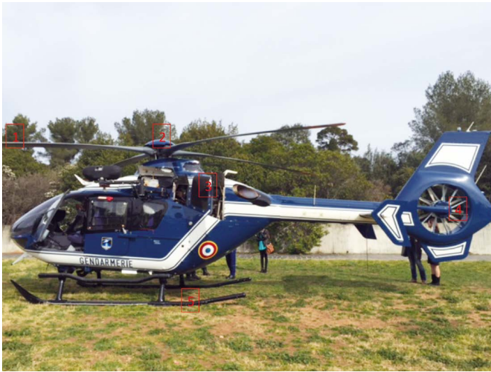
Figure 1 - Hélicoptère utilisé par la gendarmerie lors de ses interventions. 1) Pale - 2) Rotor principal - 3) Turbomoteurs (non visibles) - 4) Rotor de queue - 5) Patin.
