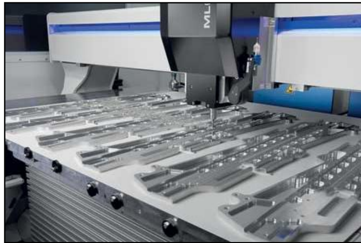
Usinage de pièces en aluminium à l'aide d'une fraiseuse à commande numérique
