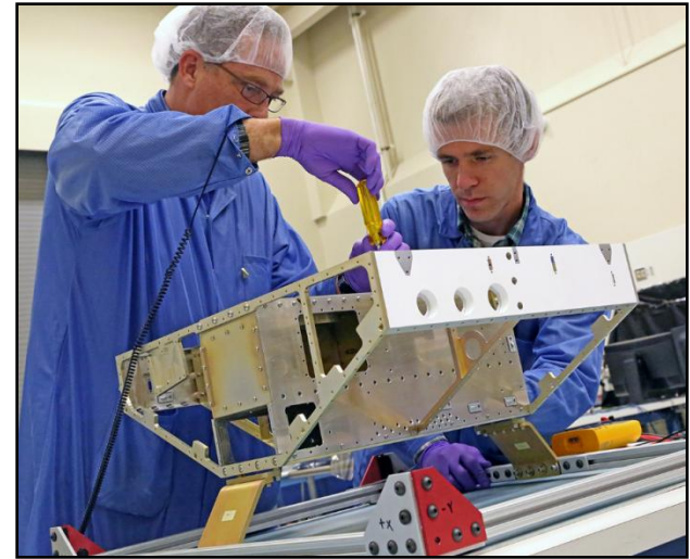
Assemblage de la structure de déploiement des panneaux solaires
