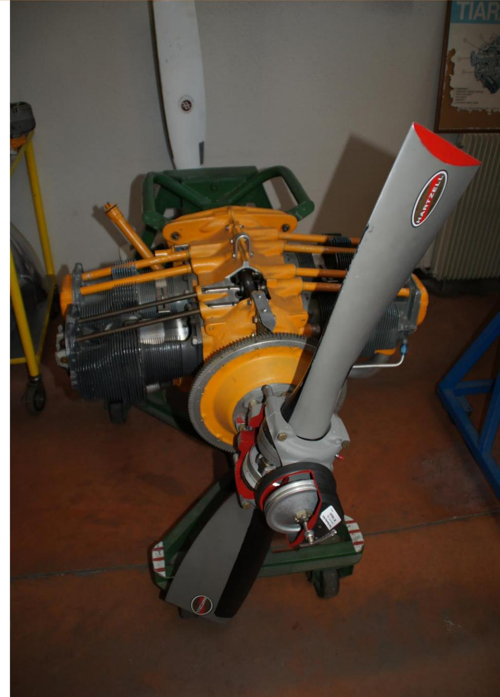
L'hélice est un dispositif qui permet de transformer l'énergie mécanique fournie par le moteur en une force tractive ou propulsive directement utilisable par l'avion pour se déplacer.
