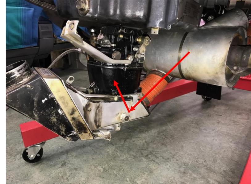
La vanne mobile dirige l'air chaud venant d'une enveloppe autour de l'échappement vers le carburateur et l'air frais vers l'extérieur
