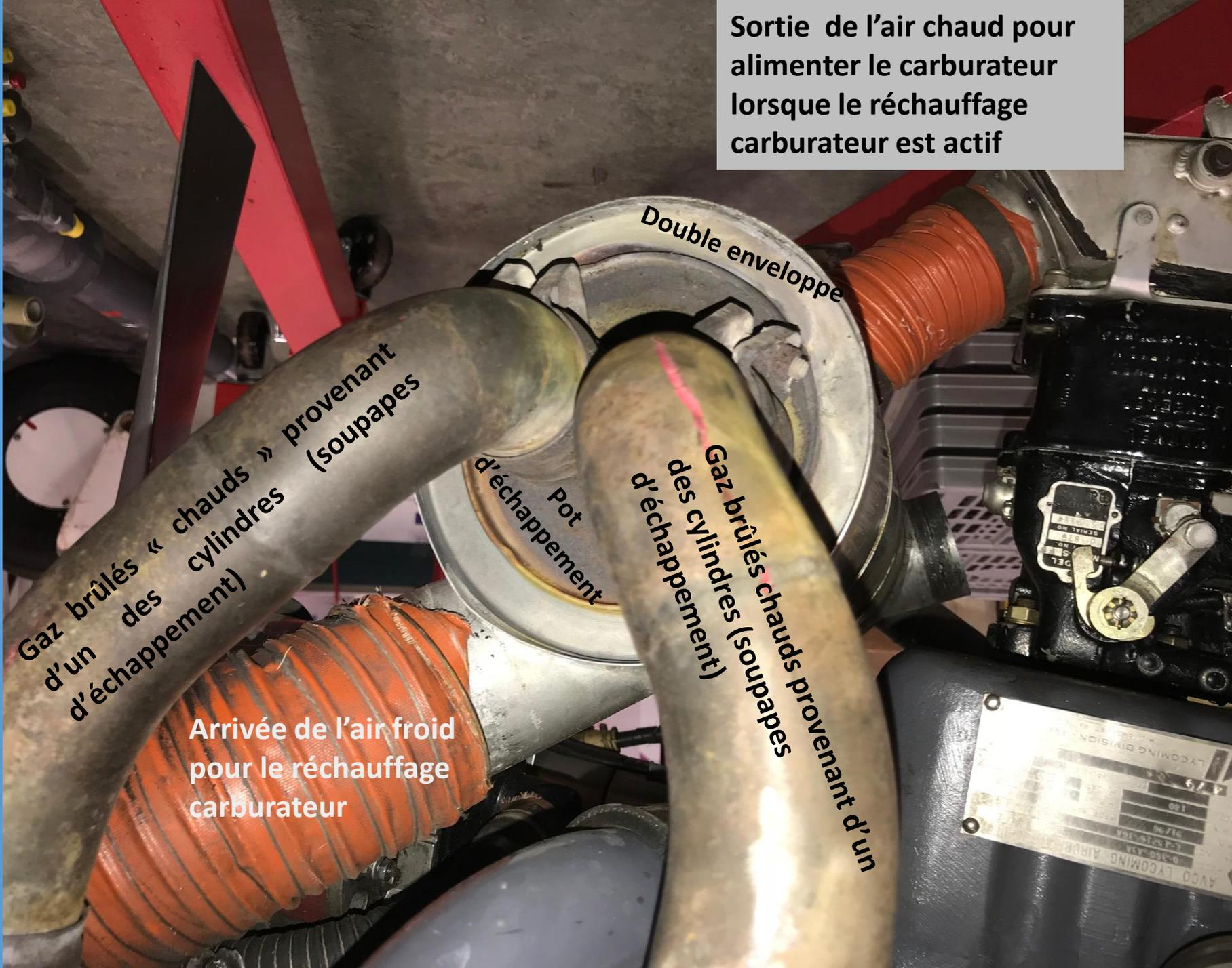
Remarque : si le réchauffage carburateur est utilisé lors de la réduction de puissance du moteur (atterrissage) il ne doit pas être utilisé au roulage au sol (air non filtré).
