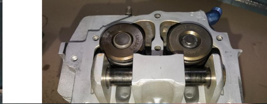
Les deux soupapes vue de dessus du cylindre
